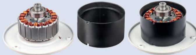
Unser kleinster und sparsamster DC/EC-Motor. Links der Stator mit den Wicklungen, in der Mitte der Rotor als Permanentmagnet. Rechts der betriebsbereite Zustand.
